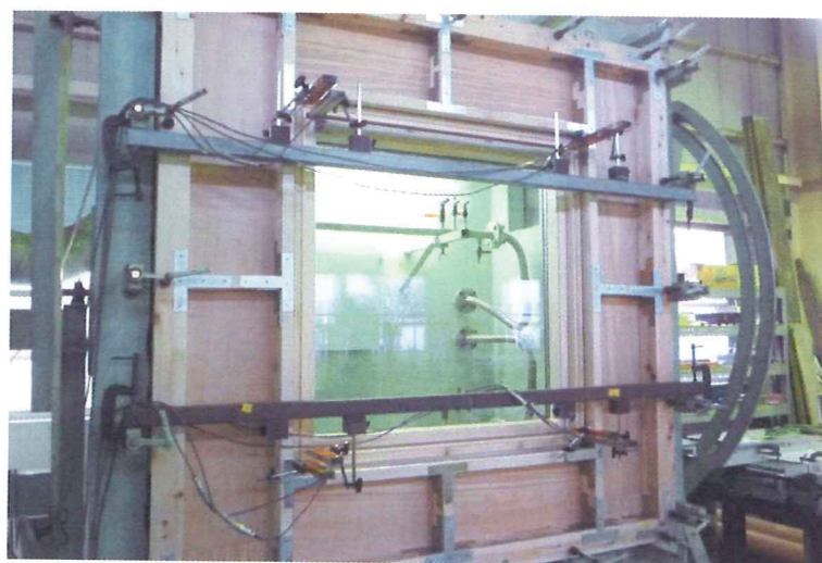
写真 4.3 耐風圧性 試験実施状況
